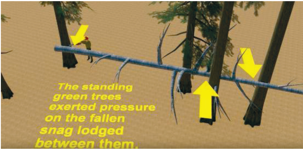
Изображение 3в: Силите, упражнявани върху дънера, изглежда, че не са правилно преценени от оператора на верижния трион преди, но и по време на рязането на дънера.
