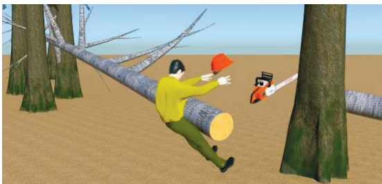
Изображение 3д: Когато рязането приключва, стъблото внезапно „се освобождава“ и удря оператора на верижния трион. Според фактите, които той успява да си припомни, след като излиза от болницата, е успял да остави резачката, точно преди дънера да го удари.
