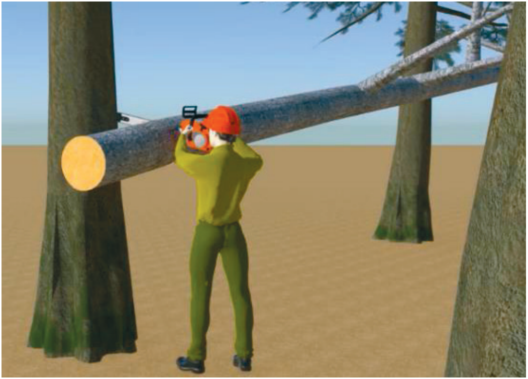
Изображение 3а: Операторът на верижния трион прави първия разрез на дървото от горната част, намирайки се от страната, където се намира дънера.
