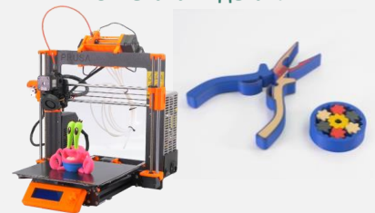
Фиг.5. Мултиматериален принтер и отпечатани детайли
